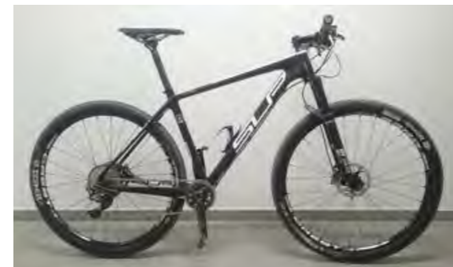
29-tolliste ratastega kerge kaaluga süsinakraamiga võistlusratas. Esikäiguvahetaja puudub lihtsuse ja kerguse pärast, kuid tagakasseti 11 hammasrattast tagavad piisava käikude ulatuse.
